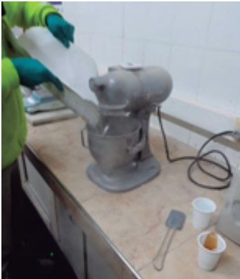
Mezcladora "Hobart" empleada para la elaboración de los morteros.
