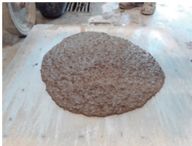
Figura 4 - Extendido del hormigón final.
